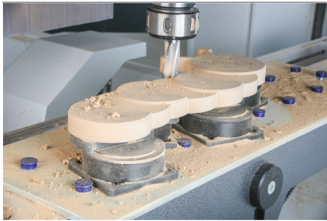
Adapter-Plates ISAP-K1 con Mono-Base y ventosas fijando piezas de madera curvadas
